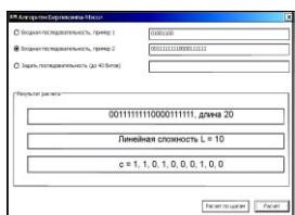
Данная модель посвящена алгоритму Берлекэмпа-Мэсси для поиска кратчайшего регистра сдвига с линейной обратной связью для поданной ему на вход двоичной линейной рекуррентной последовательности. Данный алгоритм можно использовать в шифровании для поиска ключевой последовательности.
