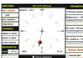
Компьютерная модель позволяет наблюдать колебания и перевороты жесткого маятника в определенном временном масштабе, позволяет строить графики зависимости от времени угла отклонения маятника и его угловой скорости, графики потенциальной, кинетической и полной энергии. Возможен просмотр фазовой траектории и потенциальной ямы маятника. Кроме того, модель содержит примеры, иллюстрирующие наиболее характерные виды колебаний моделируемой системы.
