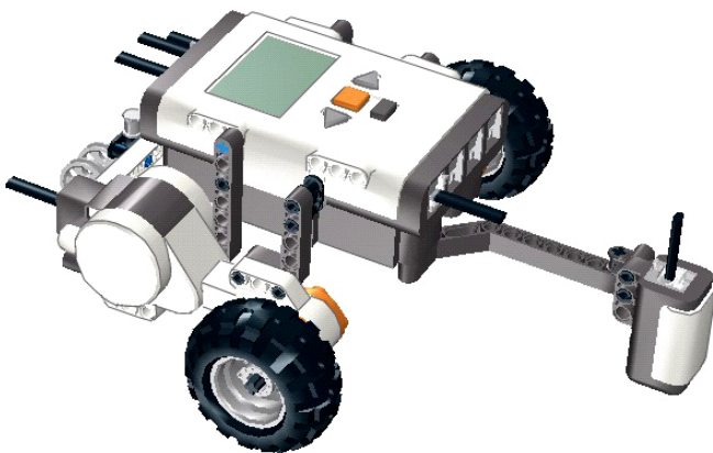
Рис. 4. Высота датчика над поверхностью поля – от 5 до 10 мм
