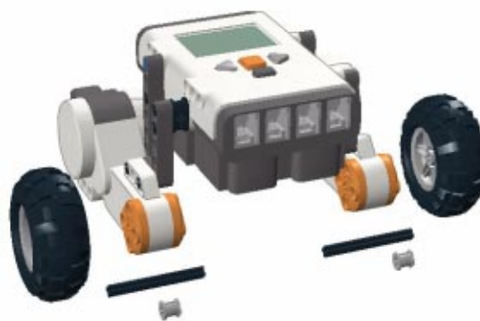
Рис. 8. Колеса устанавливаются на 6-модульные оси, втулки предохраняют от нежелательного трения о корпус
