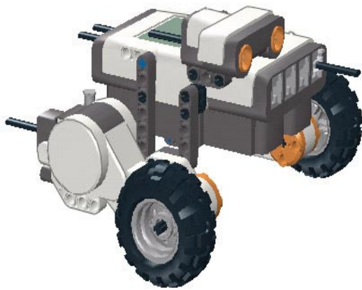
Рис. 27. Датчик должен смотреть строго горизонтально
