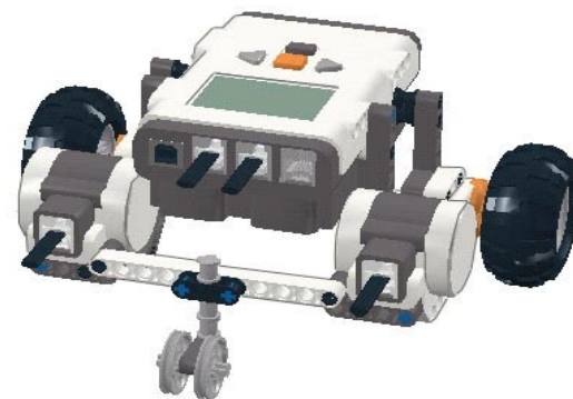
Рис. 12. Корпус такой тележки расположен горизонтально и колесико вращается вокруг вертикальной оси свободно
