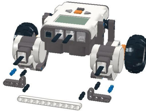
Рис. 10. Немного усложним конструкцию, подняв заднюю балку
