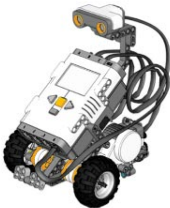
Рис. 25. Маленький исследователь из набора 9797 с ультразвуковым датчиком
