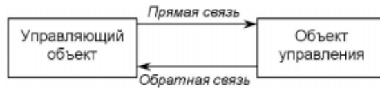
Рис. 23. Управление с обратной связью
