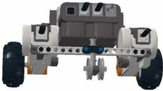
Рис. 9. Сзади моторы можно скрепить 15-модульной балкой, но тогда тележка будет слегка наклонена вперед
