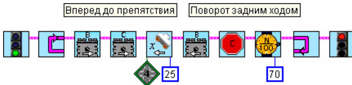
Рис. 29. Алгоритм путешествие по комнате с плавным поворотом задним ходом
