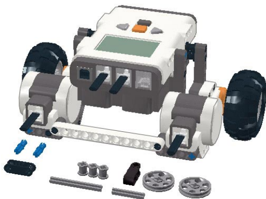
Рис. 11. Элементы подвижного колеса. Длины осей – 3 и 5 модулей. Колесики должны вращаться свободно
