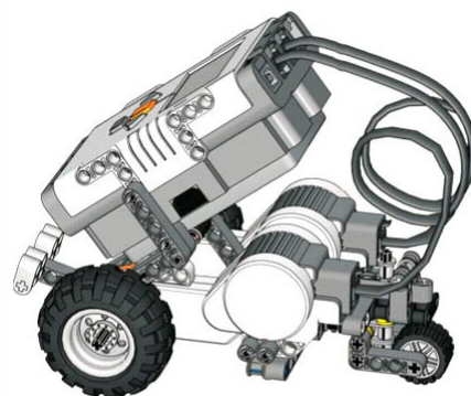
Рис. 2. Стандартная основа для робота из набора 9797
