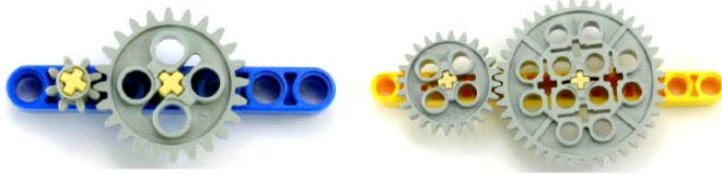
Рис. 2. Передача с понижением скорости: слева i = 3:1 , справа i = 5:3 [3]
