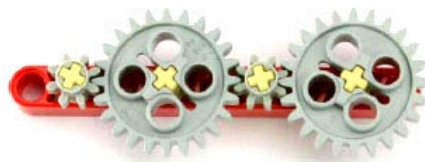
Рис. 3. Две промежуточные шестерни – паразитные [3]
