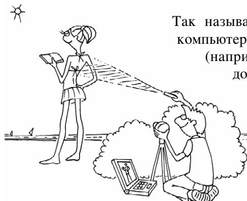
Так называемые 3D-сканеры, позволяющие получить на компьютере трехмерное изображение реального предмета (например статуэтки), – это достаточно сложные и дорогие устройства. И тем не менее, воспользовавшись обычной web-камерой, обычной же «лазерной указкой» и скаченной из Интернета специальной программой, можно изготовить самодельный 3D-сканер практически в домашних условиях.
