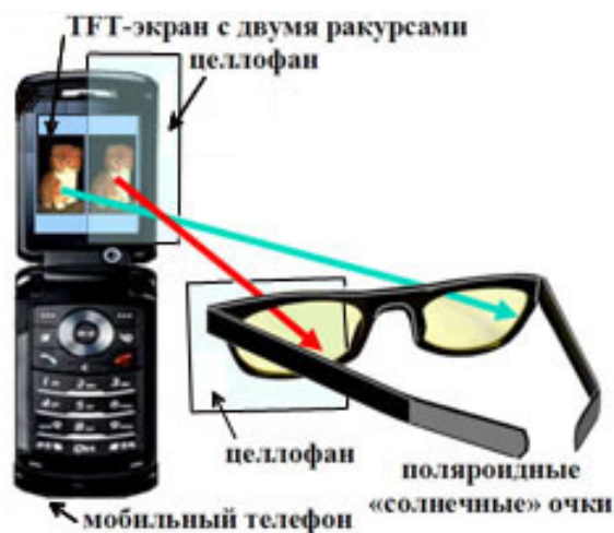
Рис. 9. Принцип использования целлофана в качестве поляризационного фильтра
