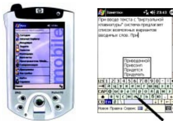
Рис. 4. Типичный КПК фирмы Hewlett-Packard: ввод текста при помощи стилуса и виртуальной клавиатуры
