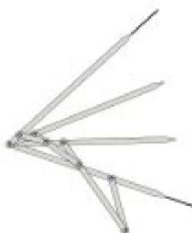
На этом Кемпе останавливается, так как для его «доказательства» теоремы «о подписи» нужен был механизм, делящий угол именно на три части. Однако очевидно, что использованный алгоритм построения можно продолжать и дальше, получая шарнирные механизмы, точно делящие произвольный угол на любое наперед заданное число частей.
