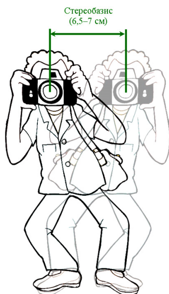
Рис. 1. Простейший способ фотосъемки стереопары обычным фотоаппаратом, «переминаясь с ноги на ногу»
