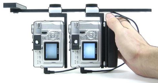
Рис. 11. «Стереоспарка» из двух цифровых фотоаппаратов (илл. с сайта http://www.pokescope.com/cameras/3d_camera_sidebar.html )
