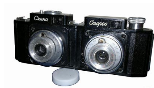
Рис. 10. Самодельная стереофотокамера из двух фотоаппаратов «Смена-2» (илл. с сайта http://fotki.yandex.ru/users/serlor080209/view/407482/?page=1 )
