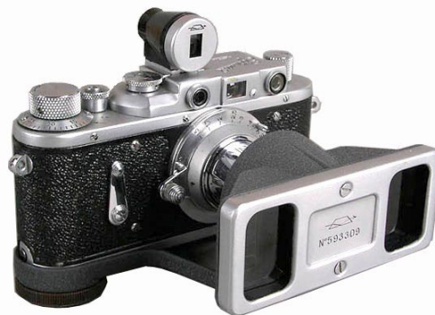
Рис. 5. Призматическая стереонасадка для зеркальных плёночных фотоаппаратов
