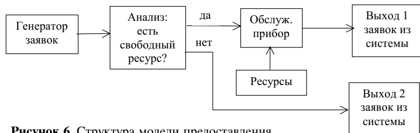
Рисунок 6. Структура модели предоставления сервиса мобильной связи.
