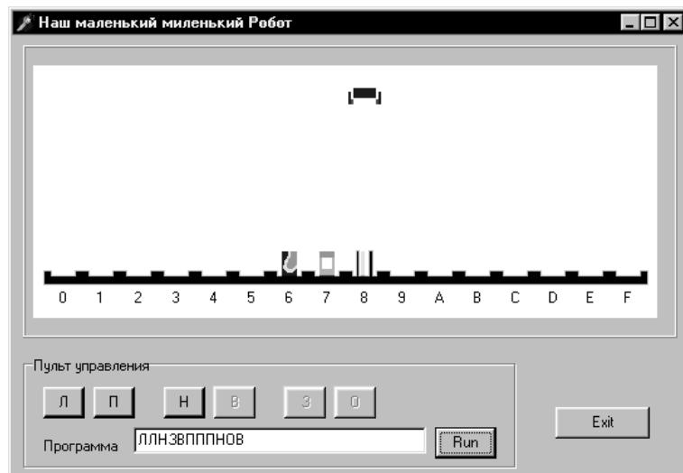
*Если набрать программу ЛЛНЗВППНОВ и нажать "Run", робот "самостоятельно" перенесет груз из гнезда № 6 в гнездо № 9. Если нажать "Run" еще раз, робот снова перенесет груз слева направо.*
