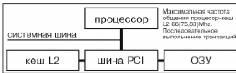
Рисунок 1. Узкие места в PC класса Pentium® (6x86, к6...)
