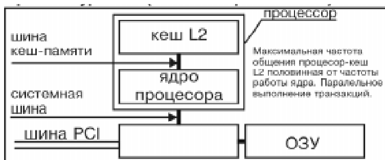
Рисунок 2. Архитектура DIB (DUAL Independent BUS)
