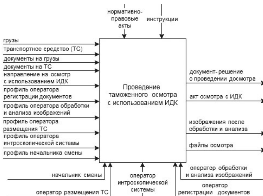
Рис. 2. Диаграмма проведения таможенного осмотра с использованием ИДК
