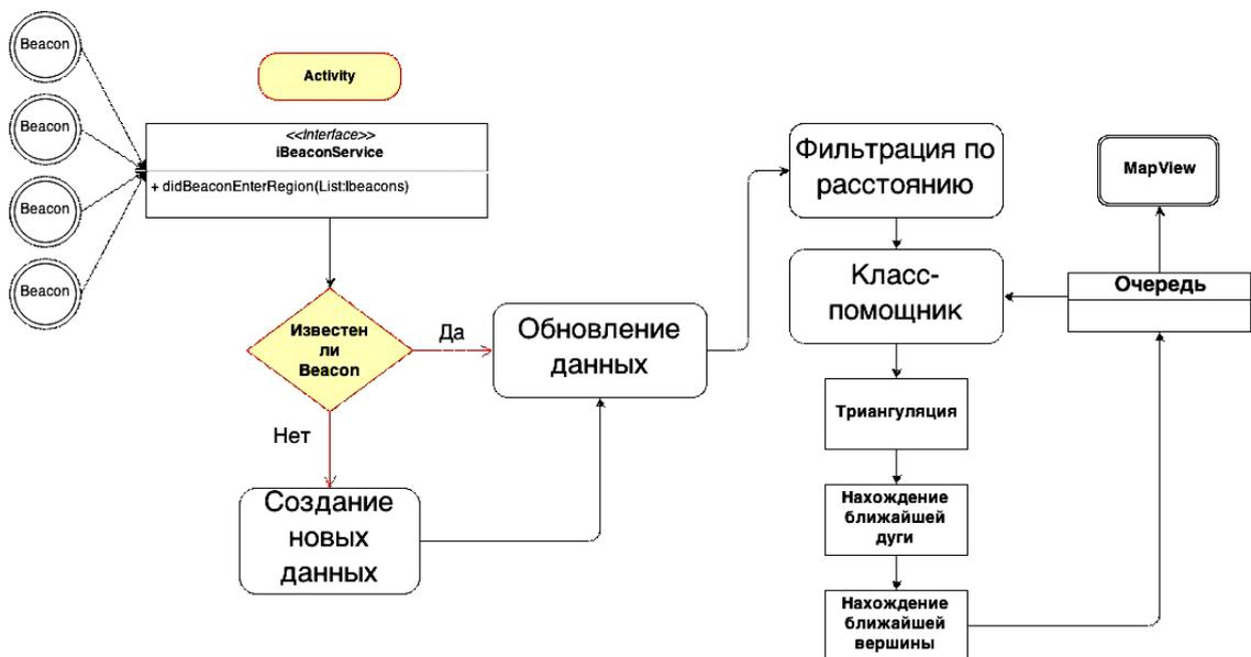
Рис. 7. Алгоритм получения и обработки данных
