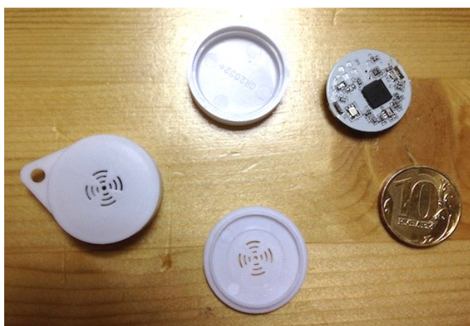
Рис. 2. Маячок, работающий по протоколу iBeacon
