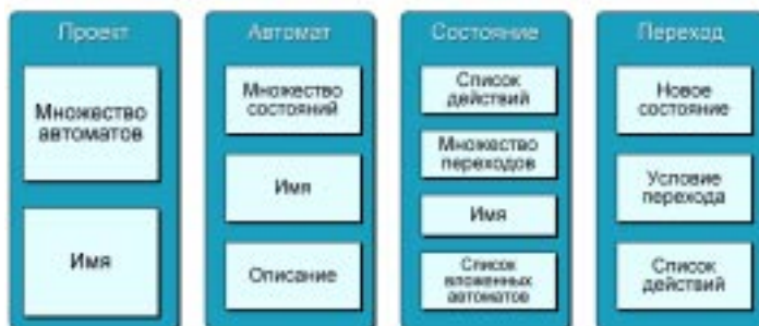
Рис. 3. Общая структура внутренней модели представления автомата
