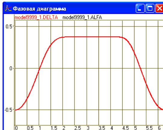
Рис. 7. Угол поворота выходного звена CD в зависимости от угла поворота входного
