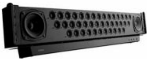
Рис. 2. Звуковой проектор со снятой крышкой: матрица звукоизлучателей.
