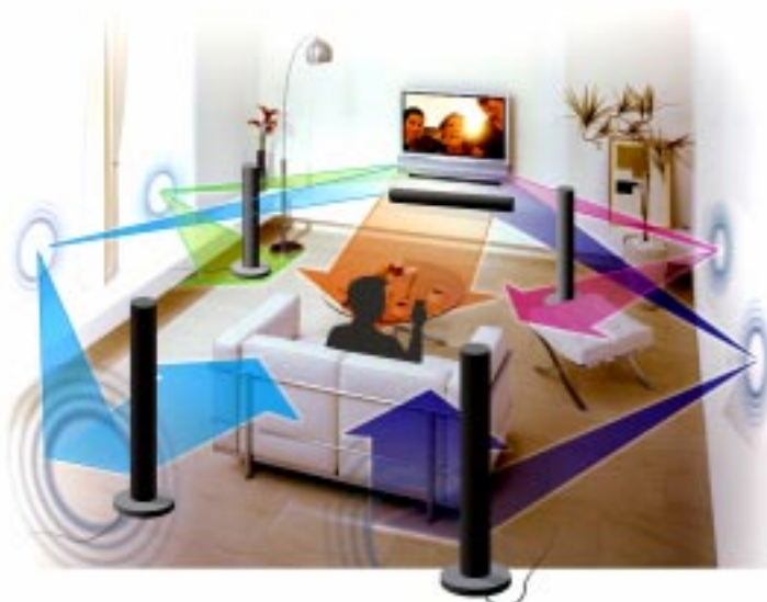
Рис. 3. Принцип действия звукового проектора: формирование пяти «виртуальных аудиокколонок».
