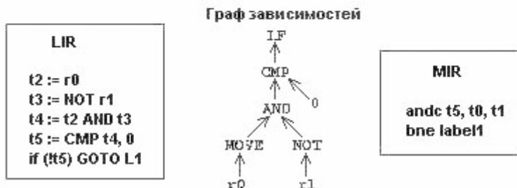
Рисунок 3. Преобразование кода низкого уровня в код машинного уровня в Jikes [4].
